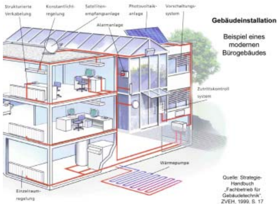
Abb. 2: Strukturierte Verkabelung für moderne Gebäudesysteme am Beispiel eines Bürogebäudes
