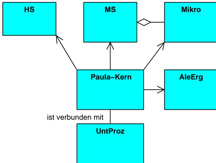
speicher (MS) besteht aus einer Reihe von Mikro-Befehlen (Mikro), weshalb diese Beziehungsart zwischen diesen beiden Klassen angebracht ist.
