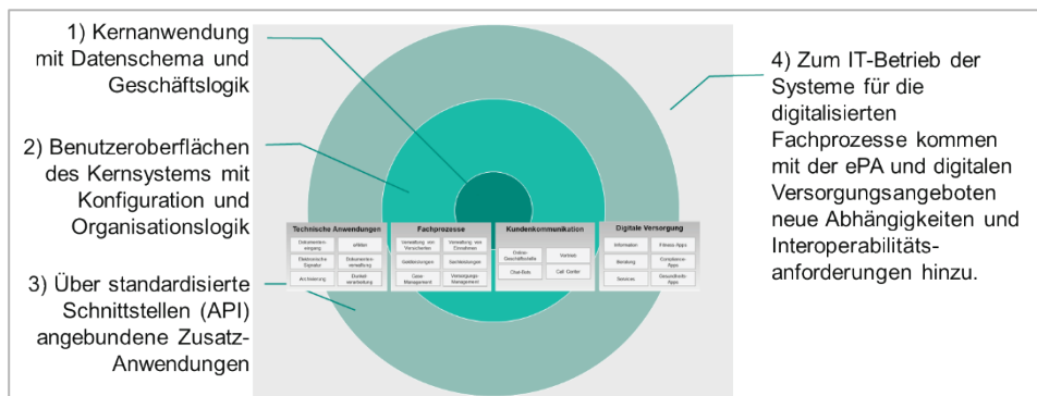
Abbildung 12: Schematische Darstellung einer typischen Krankenkassen-Software Architektur
