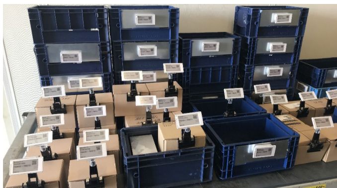
Abbildung 15: Electronic shelf labels zur adaptiven Fertigungssteuerung
