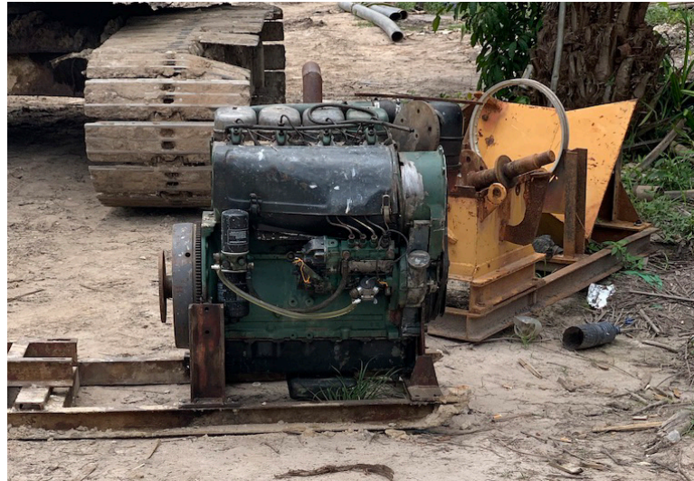
Abb. 9: Dieselmotor für das Betreiben einer sluice box (HANSMANN 2019)
