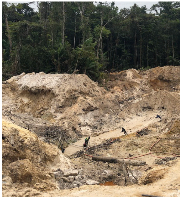
Abb. 6: Auswaschen und Hochpumpen des Sedimentschlammes (HANSMANN 2019)
