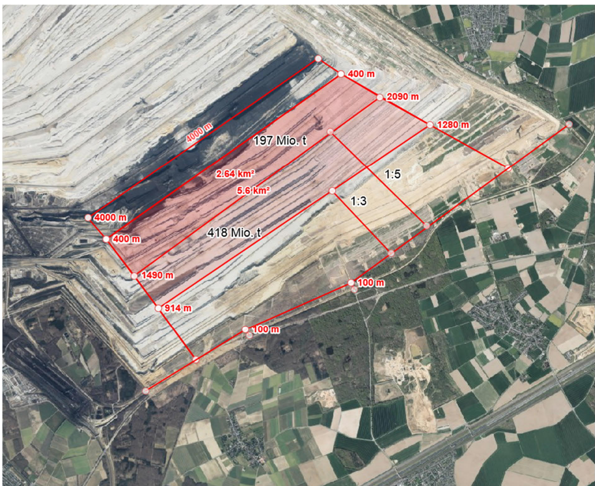
Abbildung 4: Tagebau Hambach, Gewinnungsböschung 1:3 und 1:5, Tagebaukante Stand 09/2019
