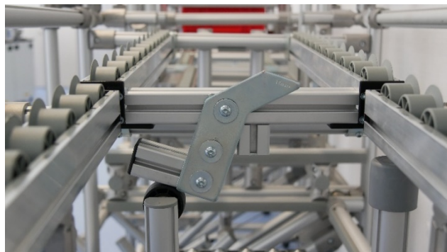
Abbildung 3: Stoppvorrichtung für eventuell nachkommende KLT
