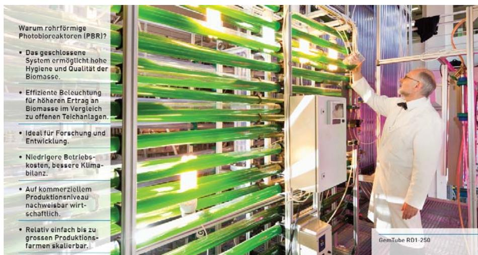
Abb. 23 Die Algenzucht in Bioreaktoren aus Kunststoffrohren wird bereits erfolgreich in Gewächshäusern praktiziert. Diese Laboranlage der Technische Fachhochschule Wildau dient u. a. der Erprobung von Outdoor- und Fassadenlösungen; [GF]
