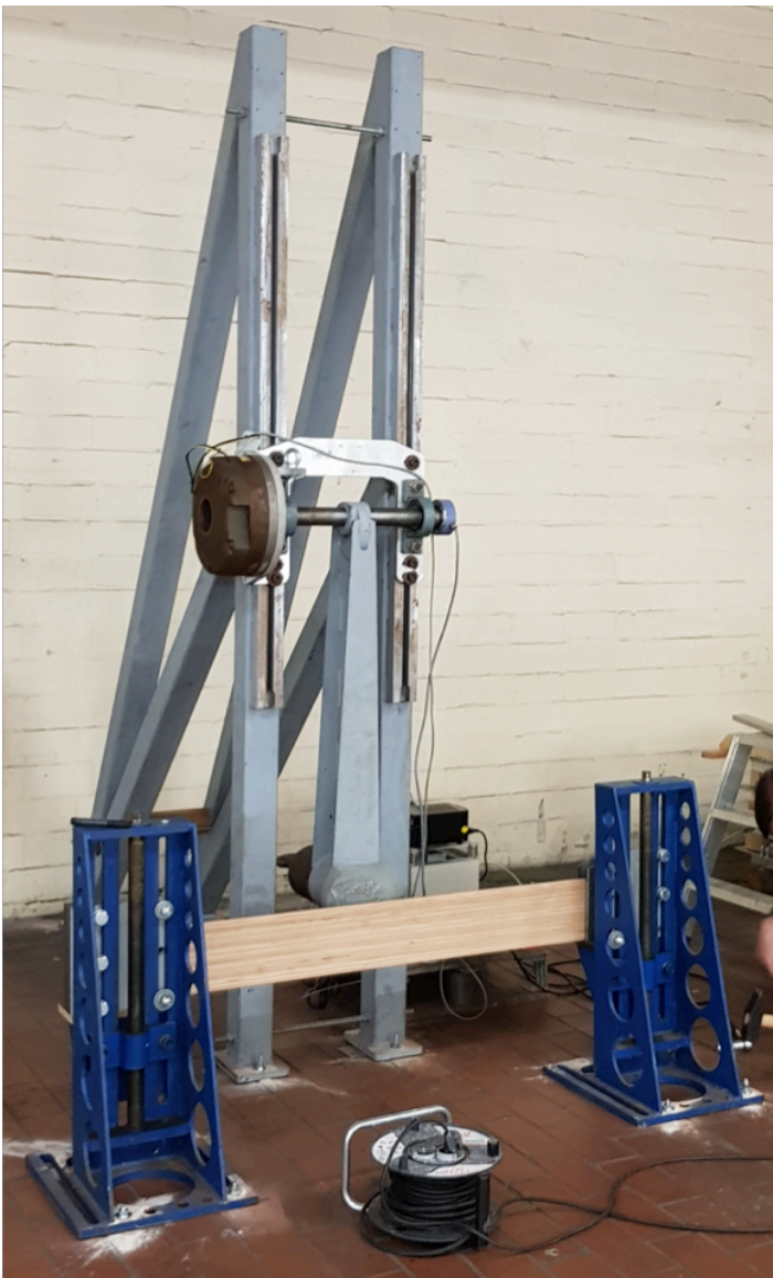
Abbildung 17: Groß-Pendelschlagwerk mit künstlichem Huf bei der Röwer & Rüb GmbH.
