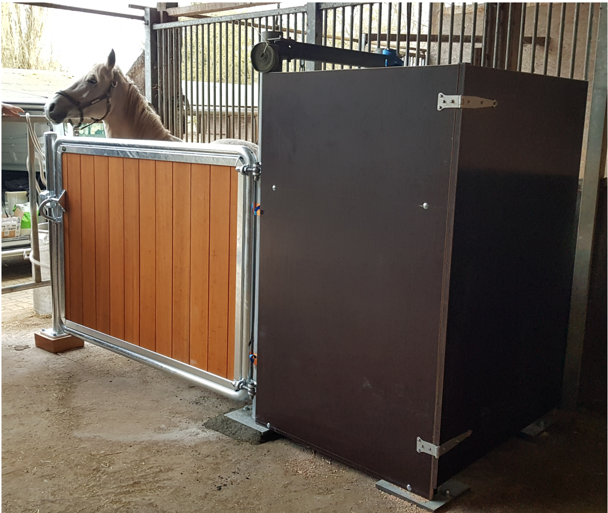
Abbildung 3: Probiertand mit Möglichkeit zur Bestimmung der beim Auskeilen wirksam werdenden Energie (Foto: Benthien).
