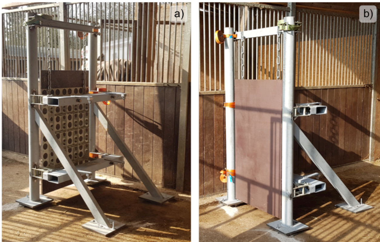
Abbildung 2: Rückansicht (a) und Vorderansicht (b) des freistehenden Grundgerüsts des Proberstandes, mit dem die beim Auskeilen wirksam werdenden Schlagenergie gemessen werden kann (Foto: Benthien).
