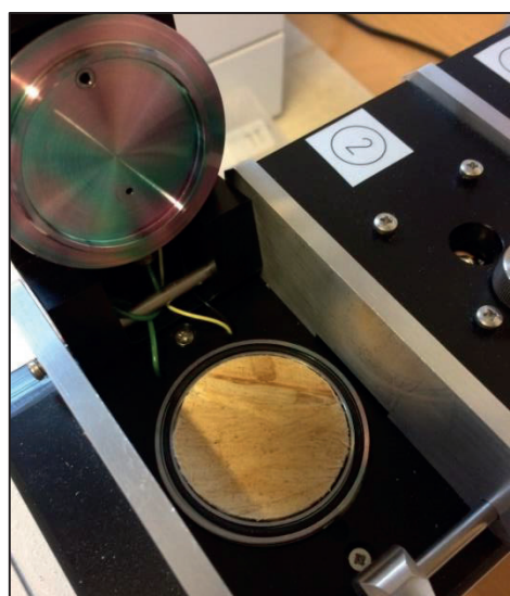
Abbildung 2: geöffnete Prüfkammer der Micro-Chamber mit OSB-Probe
