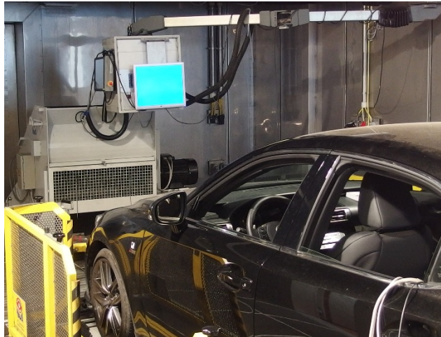
Abbildung 8: Betriebsbereites Testfahrzeug am Rollenprüfstand mit installiertem Fahrerleitsystem
