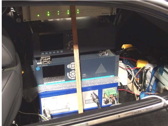
Abbildung 4: Installierte Messinstrumente im Fahrzeugfond (von unten nach oben): Verbrauchsmesstechnik (KMA-mobile)[11], 2 Leistungsmessgeräte (NORMA 5000)[17] und Präzisionsstromwandler (Danfysik)[16]
