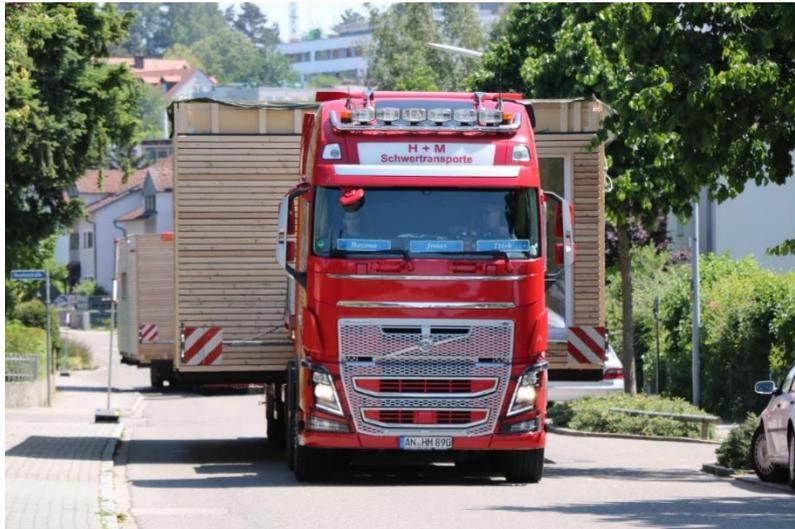
Abb. 17: Transport der Raummodule via Tieflader<sup>314</sup>
