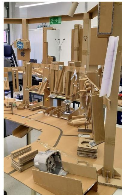
Abbildung 3: *Mockup* eines Arbeitssystems zur Getriebemontage
