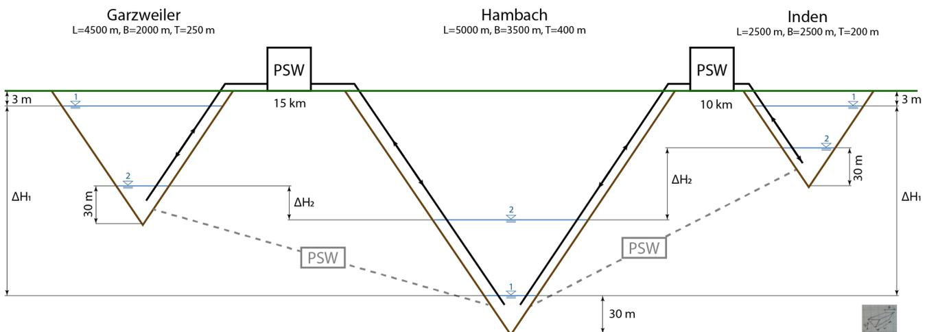
Quelle: eigene Darstellung. Erläuterung: PSW=Pumpspeicherwerk, 1=Speicher voll, 2=Speicher leer,  $\Delta H_1$ =Maximale Differenz der Wasserspiegel bei vollem Speicher,  $\Delta H_2$ =minimale Differenz der Wasserspiegel bei leerem Speicher. Bei  $\Delta H_1, \text{Garz} = 400 \text{ m} - 30 \text{ m} - 3 \text{ m} = \Delta H_1, \text{Inden}$ .
