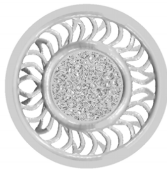
Abb. 10: Metallschauminlet in Abstandsgewirke (TinniT)
