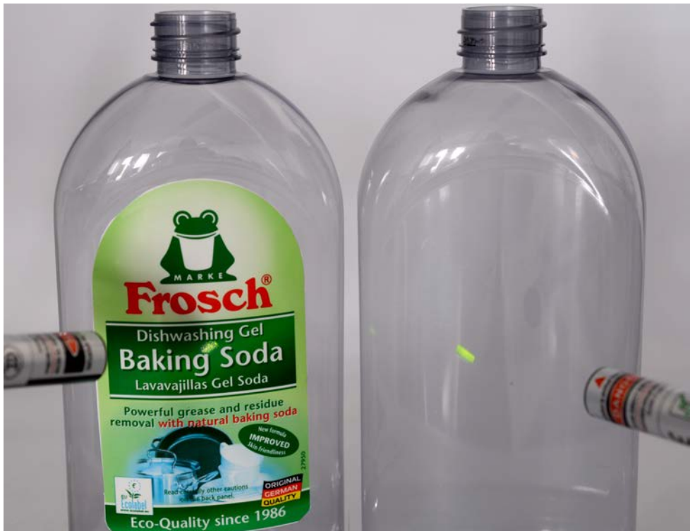
Abbildung 5: Einsatz von Markermaterialien auf Etiketten und im Packstoff (Bildnachweis: Fa Polysecure)
