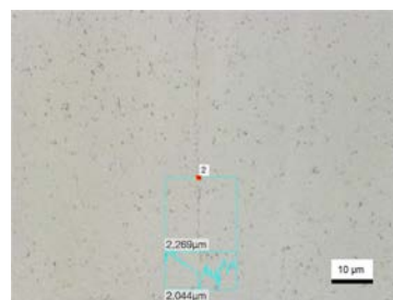
Abbildung 3: Bindenaht optimiert durch Turbotherm®
