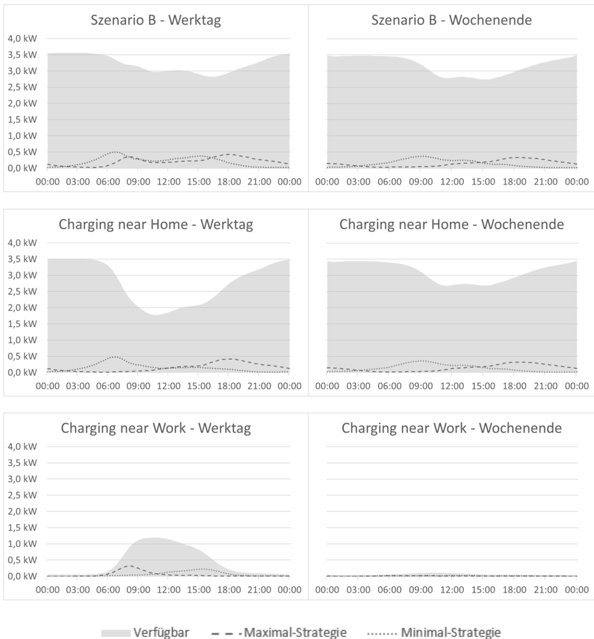
Abbildung 31: Verfügbare und geladene Energie bei Max-/Min-Strategie (Ladeszenario B).
