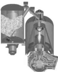
Stromerzeugende Heizung von Sunmaschine
