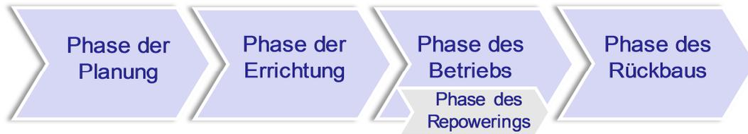
Abb. 7: Branchenspezifischer Projektlebenszyklus eines Offshore-WEP.<sup>64</sup>
