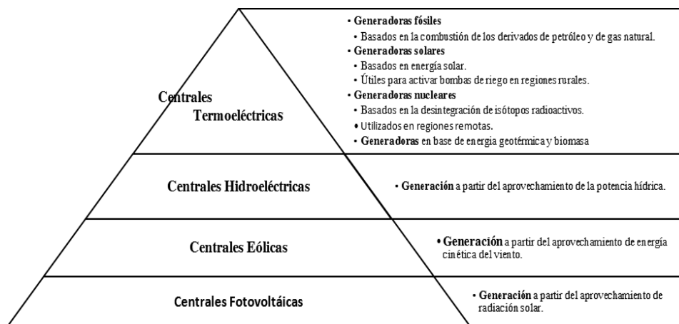
Ilustración No. 7 Centrales de Generación de Energía Eléctrica Fuente: Elaboración propia.
