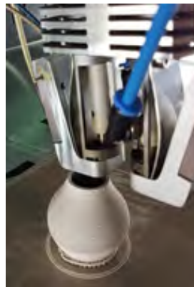
Abbildung 4: Filamentdrucker für spröde Feedstocks (drucken von ZrO_2 )
