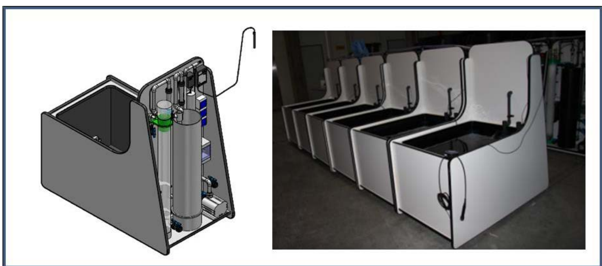
Abb. 1: Versuchsanlage in halbtechnischem Maßstab bestehend aus 12 unabhängigen Kleinkreisläufen mit jeweils eigener Wasseraufbereitung
