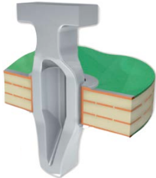
Bild 1: Schematische Darstellung eines Einpressstifts mit flexibler Einpresszone, hergestellt über Stanzen und Prägen.
