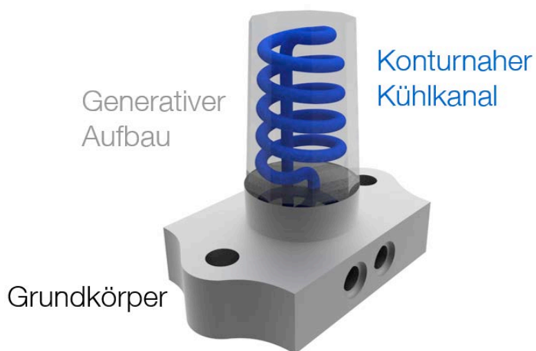
Abbildung 3 - Hybrider Aufbau eines Spritzgusswerkzeugs
