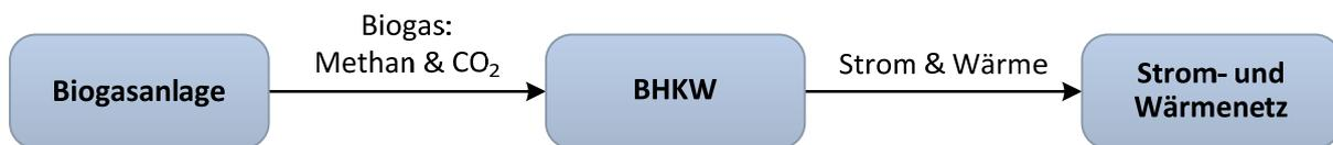
Abbildung 3: Prozessschaubild einer Biogasanlage mit BHKW, ohne Methanisierung
