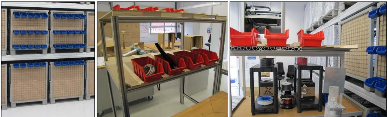
Abbildung 28: Modellhafter Aufbau des CPPS: A – Lager Standardteile; B – Zwischenlager; C – Additive Fertigung (von links)
