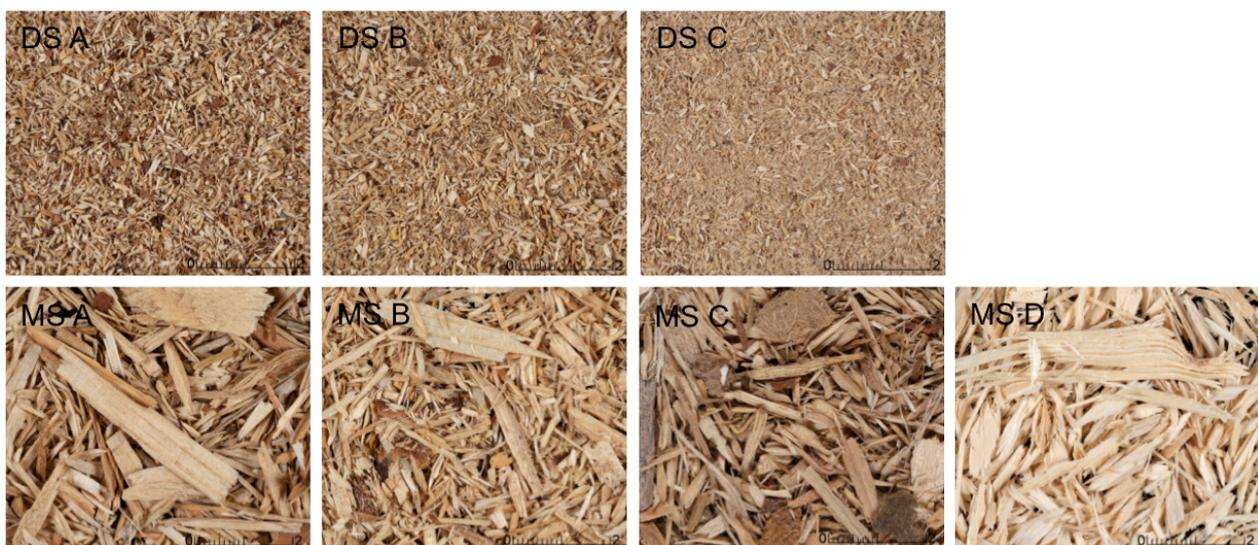
Abbildung 1: Fotografische Abbildung der verwendeten Deck- und Mittelschichtspäne.
