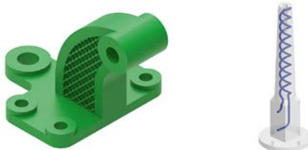
*Abbildung 6 – Bauteil mit topologieoptimierter Leichtbaustruktur (li) und kühlungsoptimiertes Spritzgusswerkzeug (re)*
