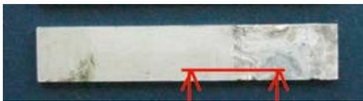
Prüfling mit verzinnter Kante nach Salznebelsprühtest
