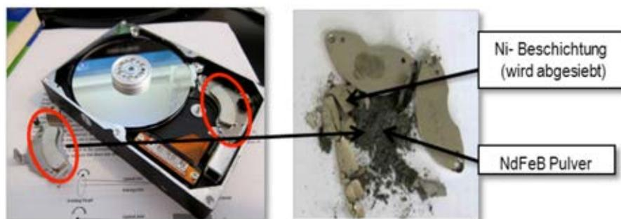
Abb. 8 links: Computerfestplatte mit Nd-Fe-B-Magnet (roter Kreis),
