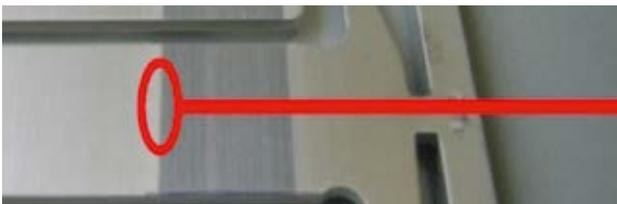
Al-plattiertes Band mit Verzinnung bis über die Al-Schicht
