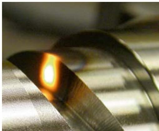
*Abbildung 2: Laserhärten an einer scharfkantigen Geometrie*
