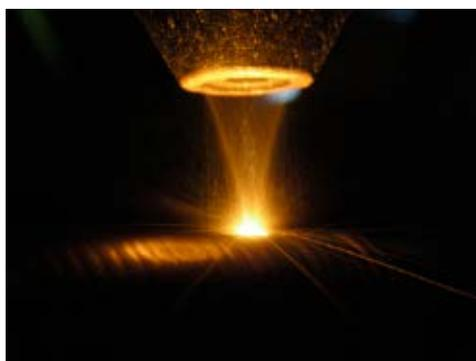
*Abbildung 5: Koaxiale Ringspaltdüse*
