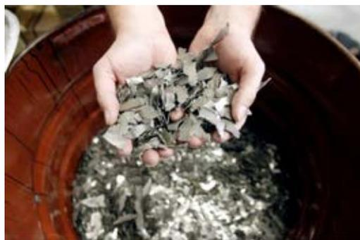
Abb. 5: Magnetabfall aus Computerfestplatten
