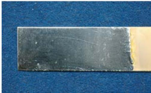
*Abb. 3 Dip-and-Look-Löttest -> Ohne Entnetzungen*
