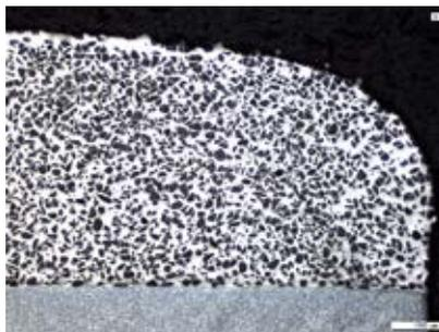
*Abbildung 6: Applizierte Verschleißschutzschicht mit WC*
