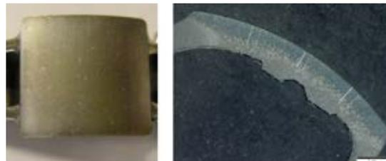
Abbildung 11: Oxidfrei lasergehärtetes Bauteil
