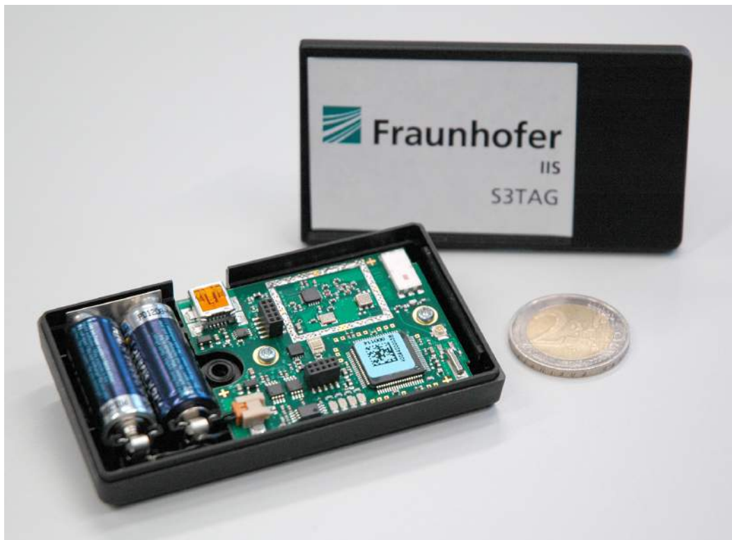
Abbildung 21: Sensorknoten S3Tag des Fraunhofer IIS
