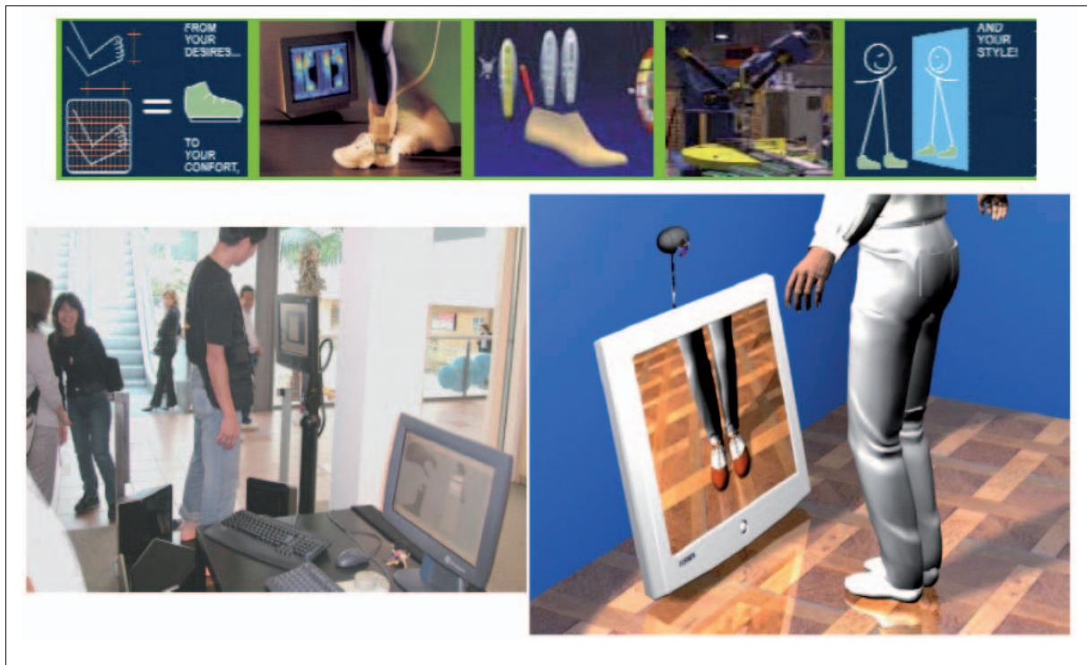
Abbildung 10: Individualisierte Massenfertigung: EuroShoe (links: Erfassung der Fußgeometrie mit 3D-Scanner; rechts: „Magic Mirror“; Quelle: Chiodi, 2003)
