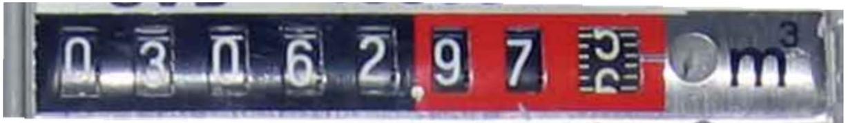
Bei dem eingeblendeten Beispiel würden Sie einen Zählerstand von 03062 m<sup>3</sup> eintragen.
