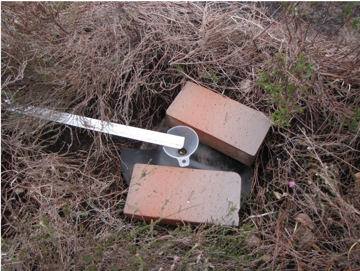
Abbildung 4.9: Unter Besenheide im Hochmoor installierter Rinnensammler.
