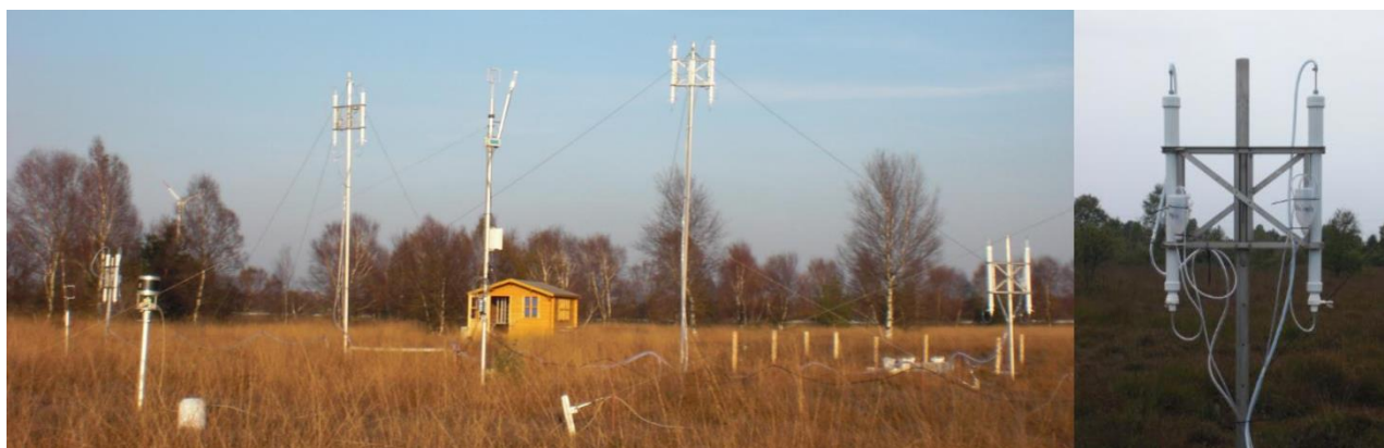
Abbildung 4.2: Aufbau des KAPS-Denudersystems am Standort Rühler Moor (links) sowie Nahansicht eines Denuderpärchens (rechts).
