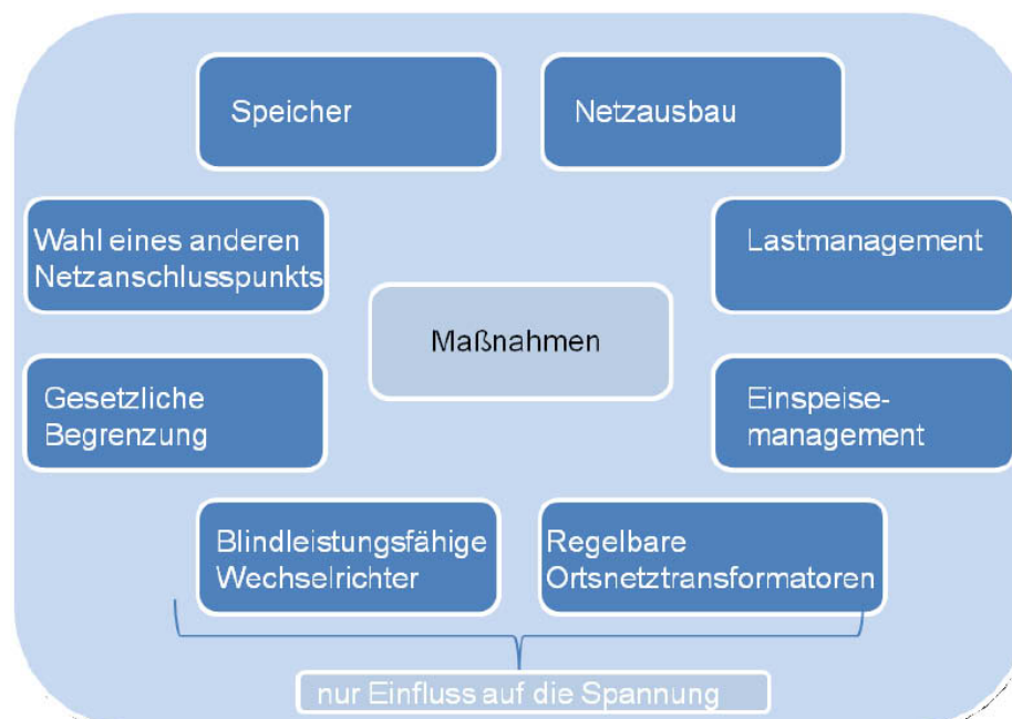
Abbildung 1-3: Mögliche Maßnahmen zur Integration von erneuerbaren Energien im Verteilnetz 15
